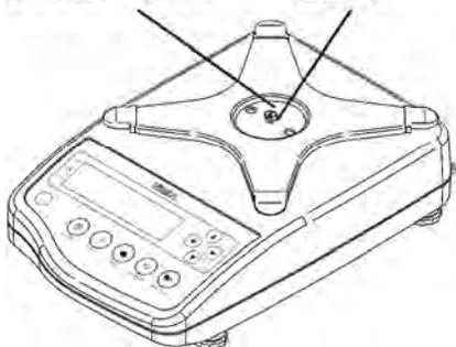
本体の突起にあわせてパンベースを載せ、コインなどでネジを回して固定します。
