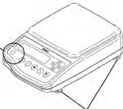
底面4箇所のアジャスタを左右に回して傾きを調節
