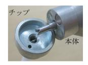
3) チップが本体から外れないよう手で押さえ、本体のノックボタンをノックしてください。<u>顕微鏡でチップ先端を観察しながら、ノックすることをお勧めします</u>。新しいチップや長時間使用していないチップを使用される場合は、5~10回程度ノックし、粘着剤を吐出させてご使用下さい。それ以外のときは、1~2回ノックすれば、適量の粘着剤が吐出できます。
