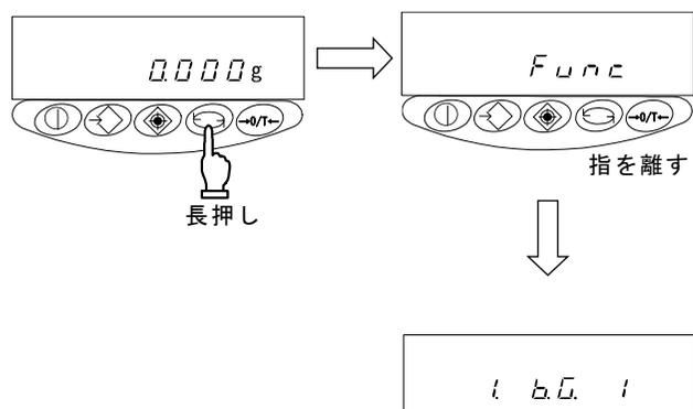
Function キーを押し続け、『Func』と表示したら指を離します。ファンクションの設定に変わり、最初の項目が表示されます。
