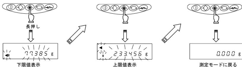
2. 操作を誤った場合、実量設定時は **Function** キーを押し、数値設定時は **Set** キーを押します。操作が中断しますので、最初からやり直して下さい。
