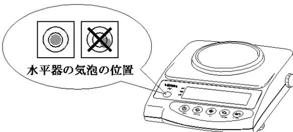
水平器の気泡が赤丸の中に入るように、アジャスタを回しながら調整します。
