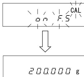
ひょう量の校正が終ると、元の測定モードに戻ります。
