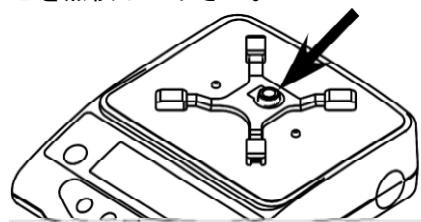
水平器の気泡が赤丸の中に入るように、アジャスターを回しながら調整します。
