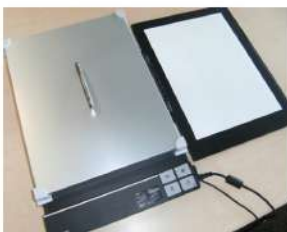
②UVスケールを適用スキャナーにセットして、発色サンプルを読み取ります。
