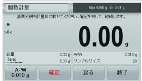
基準分銅を計量皿に置き[確定]にタッチして値を取得すると、画面に個数が表示されます。
