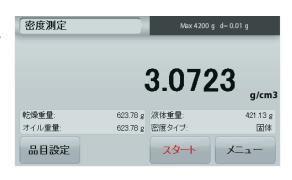
必要な計量値を得たら、サンプルの密度が g/cm³ 単位でアプリケーション画面に表示されます(空気中の計量値、水中での計量値も表示されます)。
