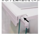
3. クリーニング後、1 の突起部分を押しな 天びんの背面のストッパーが他のガラ ス面と平行になるように溝に沿ってドア
