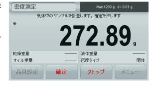
ステップ 2/3 - 空気中で油浸サンプルを計量します。
