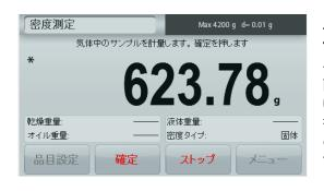
ステップ 2/2 - 液体に沈めたサンプルを計量します。 画面の指示に従い、[確定]を押してサンプルの計量値を保存します(液体に沈めた時)。
