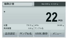
[Auto Optimization (自動最適化)]:On に設定すると、部品を追加するたびに重量が自動的に再計算され、計数の精度が上がります。デフォルトは Off です。
