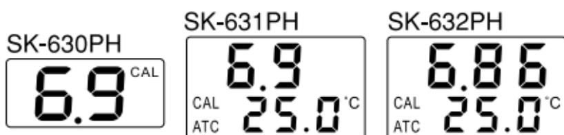
図はpH7：中性りん酸塩標準液pH6.86 (at 25°C) のとき
