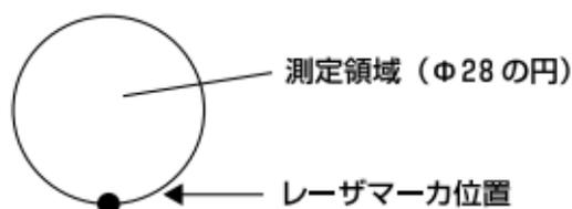
測定距離が280mmのとき、レーザーマーカは測定領域の下の位置を指します。
