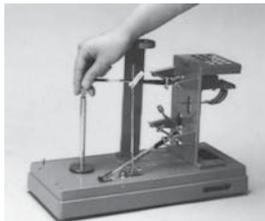
6 円筒軸上部の円筒押えナットをはずす。
