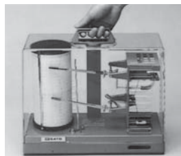
19 キャリングハンドルを右に、止まるまで回してセット完了です。
