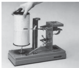
10 円筒を円筒軸に取り付ける。
